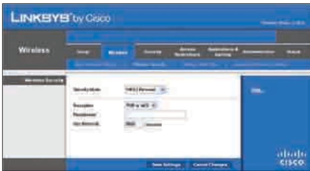
Security Mode (Modo de seguridad) > WPA2 Personal
